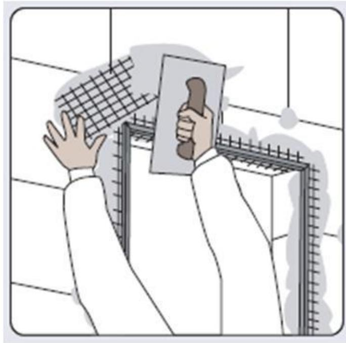
Mediante el uso de la perfilera auxiliar, reforzar todos los vértices de la fachada.
